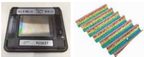
Etalon drsnosti 3 \mu\text{m}
